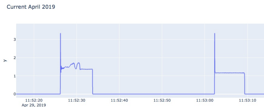
Abbildung 25: Stromstärkenverlauf (y-Achse) mit deutlich sichtbarem anomalem Verhalten beim Öffnen
