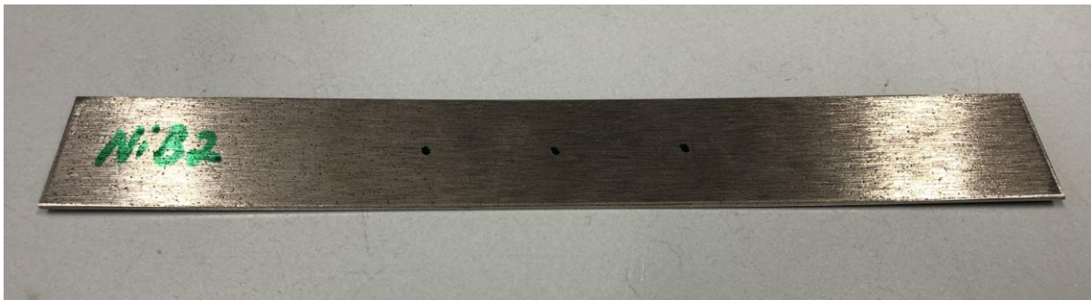
Abbildung 79: Aufnahme einer Streifenprobe „NiB2“ aus Nickel 99,96 für mechanische Prüfungen
