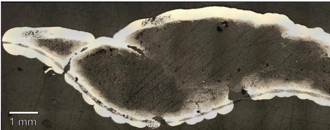
Abbildung 87: Lichtmikroskopaufnahme der Probe aus dem Versuch SP07 mit zusätzlichem Auftragen von Netzmittel vor der Nickelabscheidung
