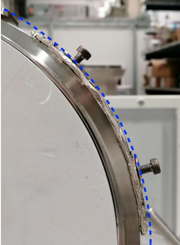
Abbildung 109: Nahaufnahme des adaptierten Designs mit dem angepassten Radius
