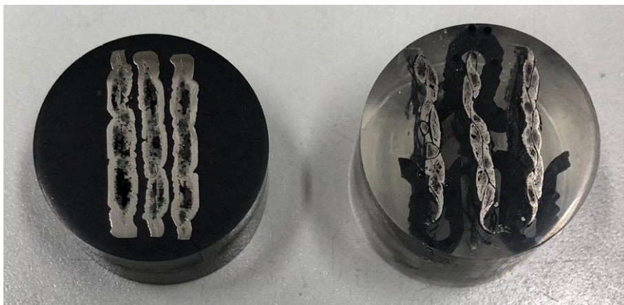
Abbildung 50: Aufnahme von heiß (links) und kalt (rechts) eingebetteten Proben zur Präparation für die metallographische Untersuchung im Lichtmikroskop
