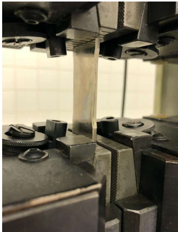
Abbildung 80: Aufnahme einer eingespannten MMC Probe für den uniaxialen Zugversuch
