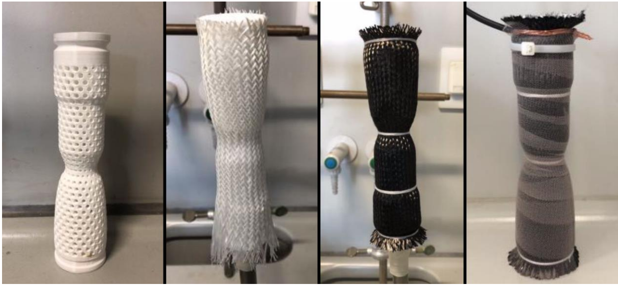
Abbildung 21: Arbeitsschritte zur Vorbereitung von Probenkörpern aus Kohlefaser-Gewebesläuche: loses Mandrel, mit Glasfaserschlauch, mit Kohlefaserschlauch und mit Nylon Gewebe (li nach re) [35]
