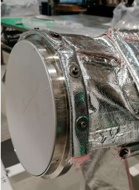
Abbildung 110: Breadboard Bracket mit Isolation auf dem Mock-up
