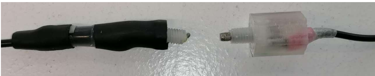
Abbildung 38: Kontaktierschrauben erster Iteration mit eingeklebtem Draht (links) bzw. zweiter Iteration mit M3 Edelstahlschraube (rechts) als Kern
