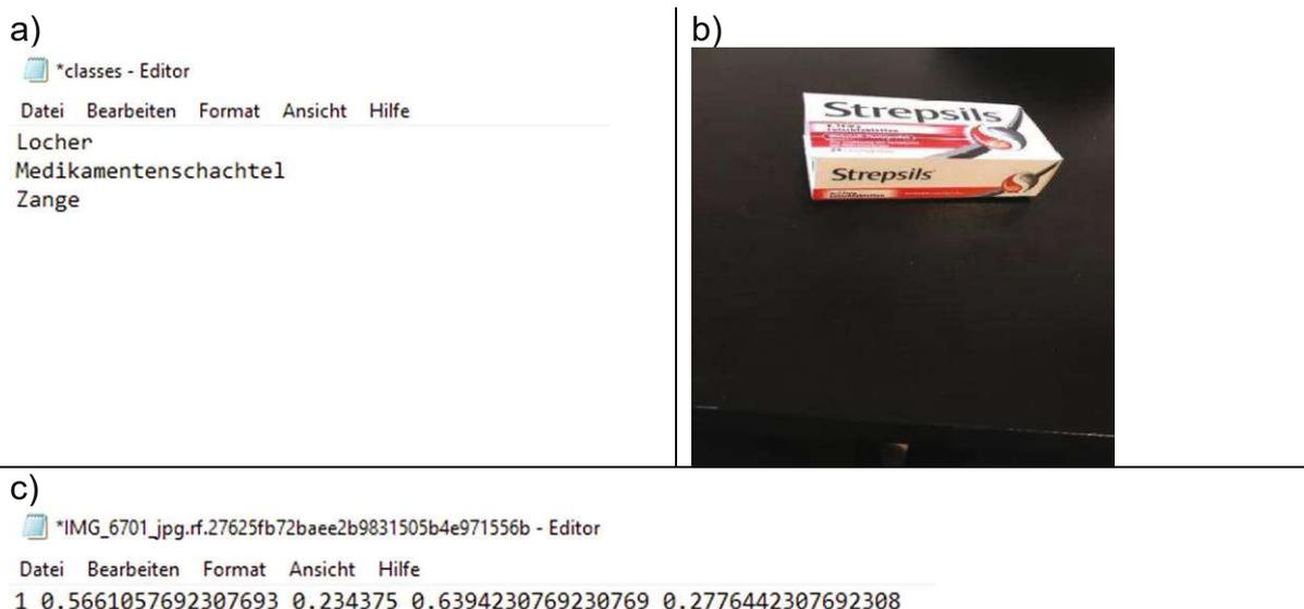
**Abbildung 43: a) Darstellung der classes.txt-Datei, b) Bild aus dem Datensatz vom Objekt Medikamentenschachtel, c) .txt-Datei nach dem Labeling-Prozess**
