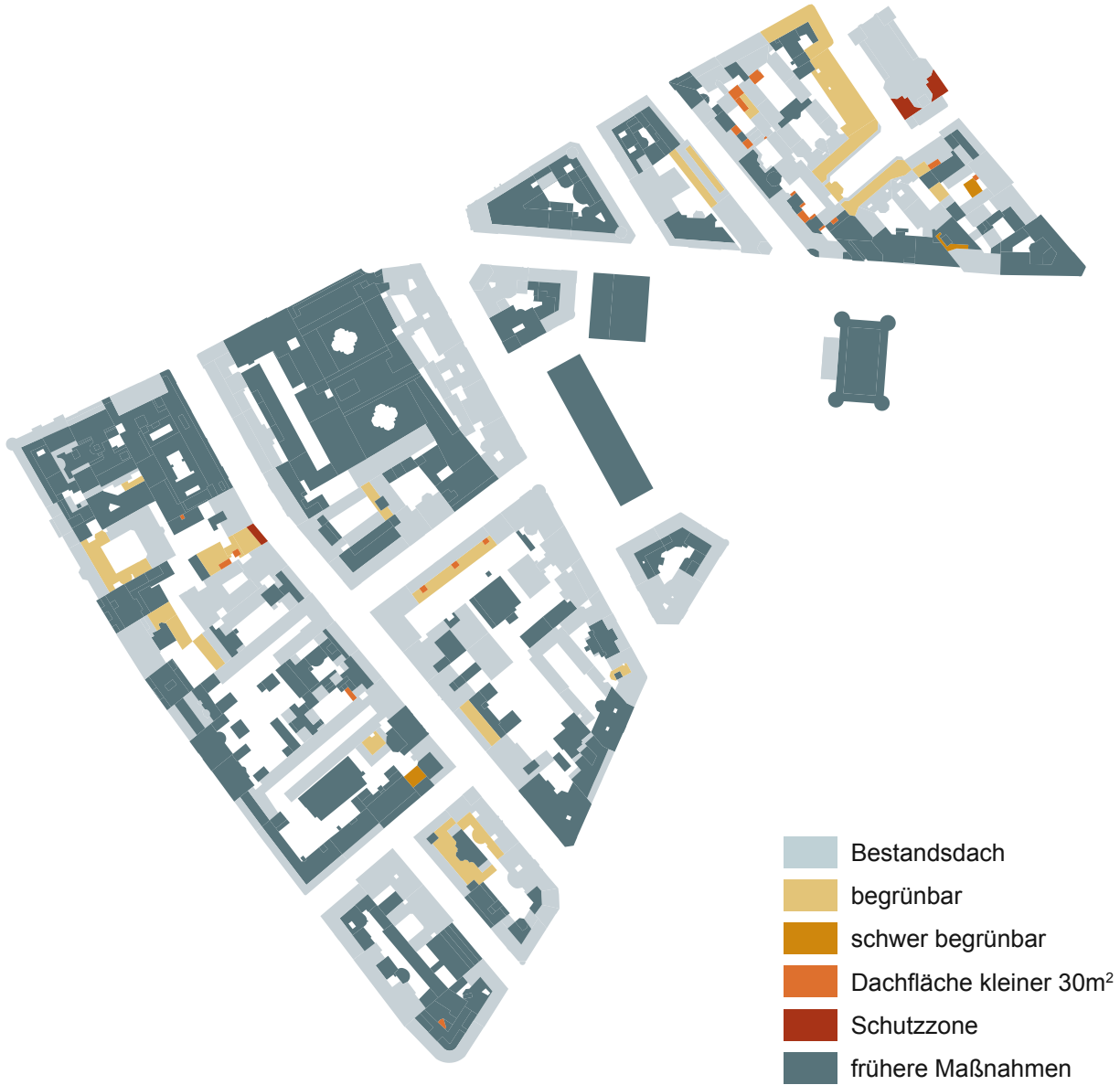
Abb.148: mögliche Begrünungen von Dachflächen mit einer Neigung von bis zu 15°, im Analysegebiet
