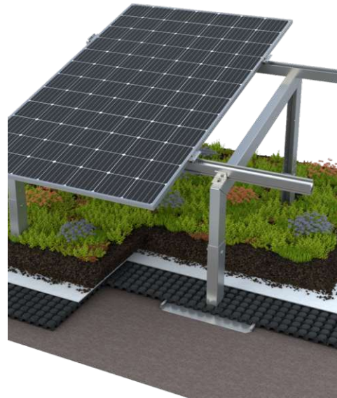
Abb.98, 99: Beispielsaufbau: extensives Solardach mit Neigung von 0-5°; Konstruktion Solardach
