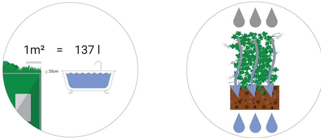
Abb.75, 76: Regenwasserrückhalt und Regenwasserfilterung durch das Gründach
