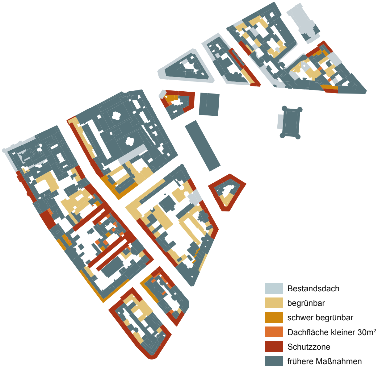
Abb.154: mögliche Begrünungen von Dachflächen mit einer Neigung von 30-45°, im Analysegebiet
