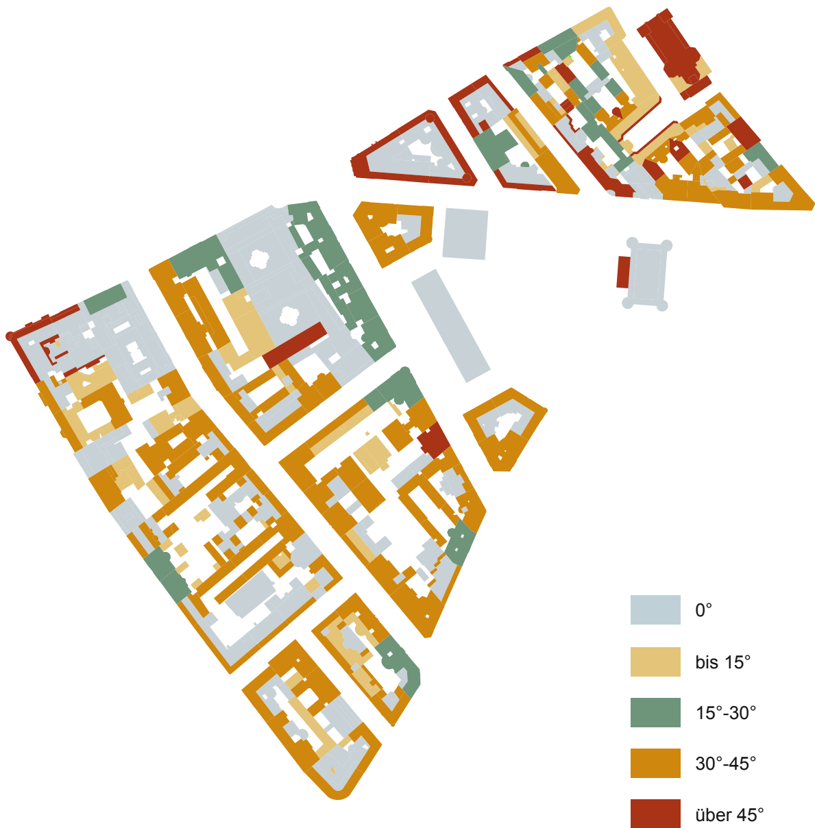
Abb.114: Dachneigungen im Analysegebiet (M1:5000)
