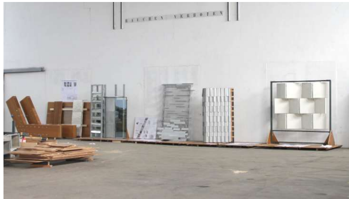
Abb. 4-2: Re-Use Bauelemente aus alten Wandverkleidungen, abgehängten Decken und anderen „geschürften“ Werkstoffen
