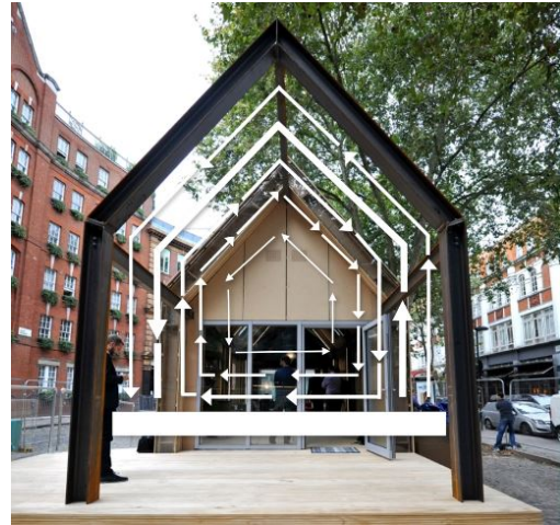
Abb. 2-48: Anwendung des Schichtenmodells von Stewart Brand am Circular Building
