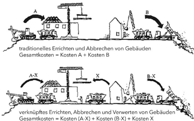
Abb. 2-12: Gegenüberstellung der Bauwerkserrichtung ohne und mit Verwertung von Recycling-Baustoffen
