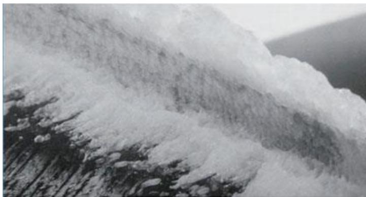
Abbildung 5 Ausbildung von Mischeis an der Tragflächenvorderkante [17]
