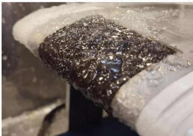
Abbildung 96 Aufnahme der Vereisung am Tragflächenprofil mit kontinuierlicher Silikonölversorgung
