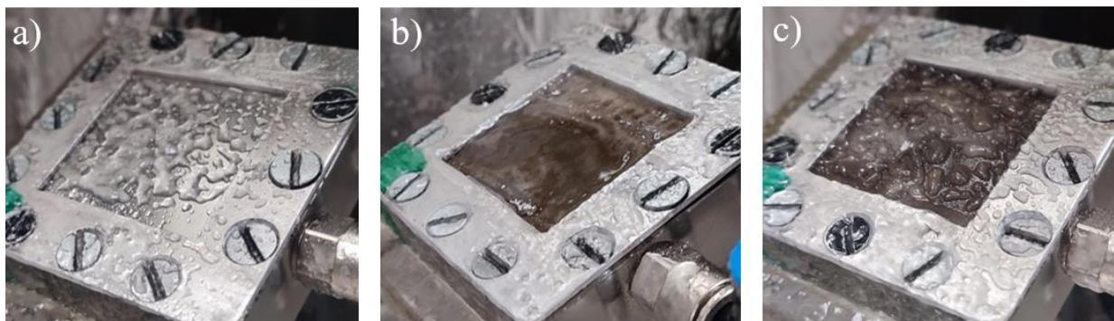
Abbildung 91 Aufnahmen nach den Vereisungsversuchen bei a) dem unbenetzten Blech, b) der unbenetzten DIMPLES-Struktur und c) der benetzten DIMPLES-Struktur
