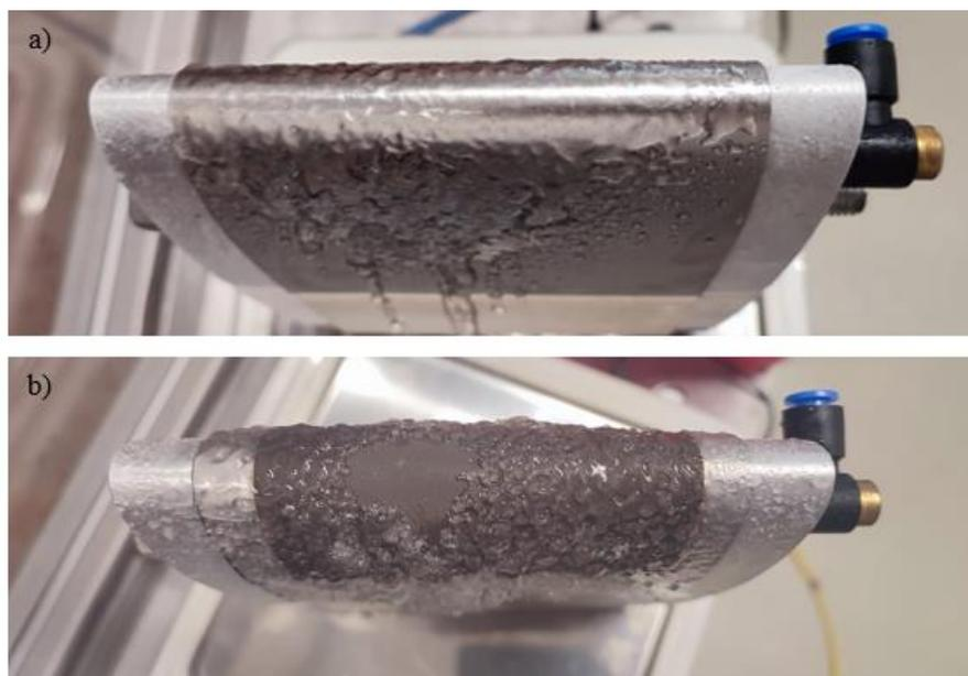
Abbildung 94 Aufnahmen der Vereisung am Tragflächenprofil am a) unbehandelten Blech und b) benetzten Blech
