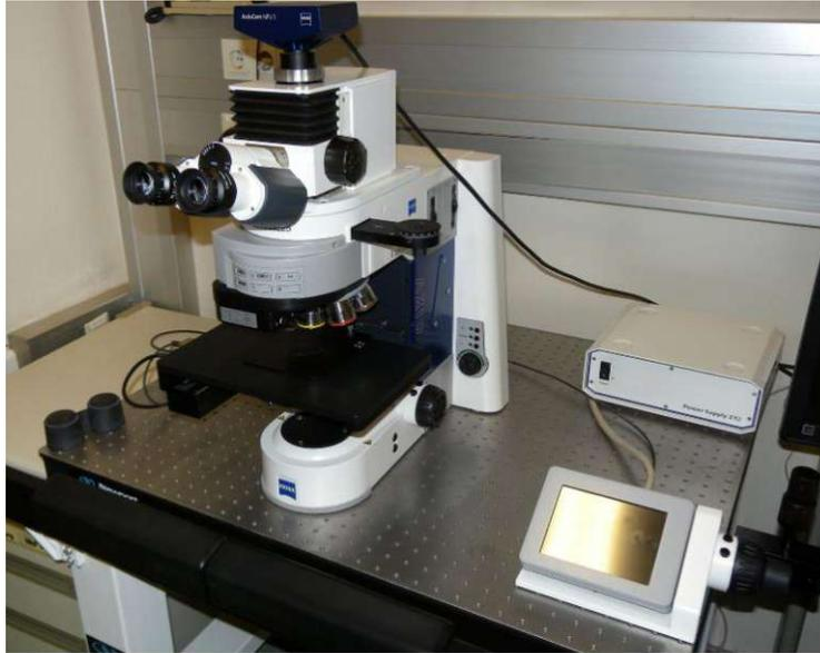
Abbildung 70 Zeiss AxioImager Mikroskop
