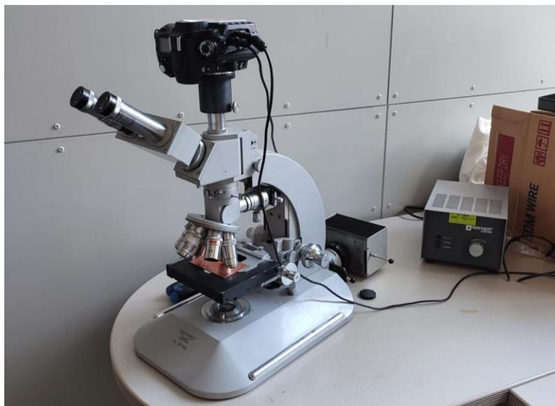
Abbildung 69 Mikroskop Reichert Zetopan mit angeschlossener Kamera Nikon D90
