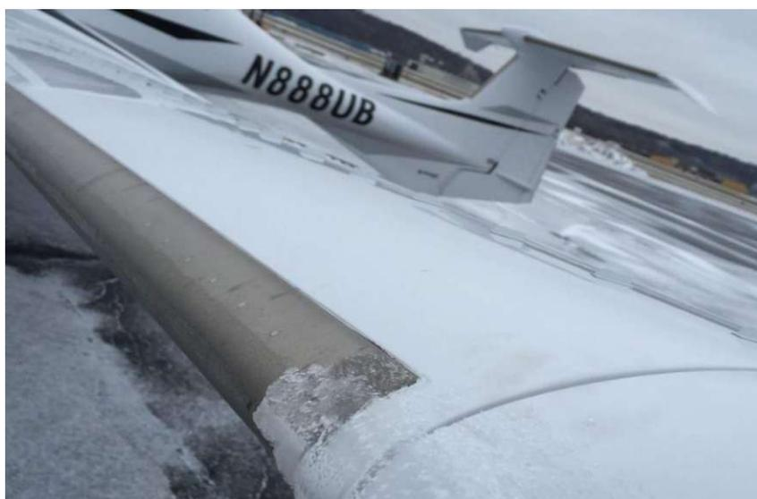
Abbildung 10 Eingebautes TKS-System an den Tragflächenvorderkanten eines Kleinflugzeuges [24]
