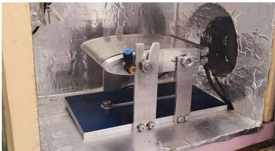
Abbildung 92 Tragflächenprüfstand mit unbehandeltem Blechzuschnitt eingebaut in die Testsektion des Klima-Windkanals
