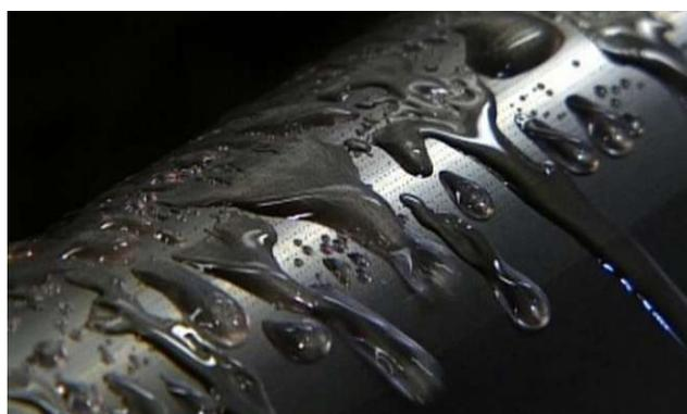
Abbildung 11 Verteilung von Enteisungsflüssigkeit durch kleine lasergebohrte Löcher auf der Tragflächenvorderkante [24]
