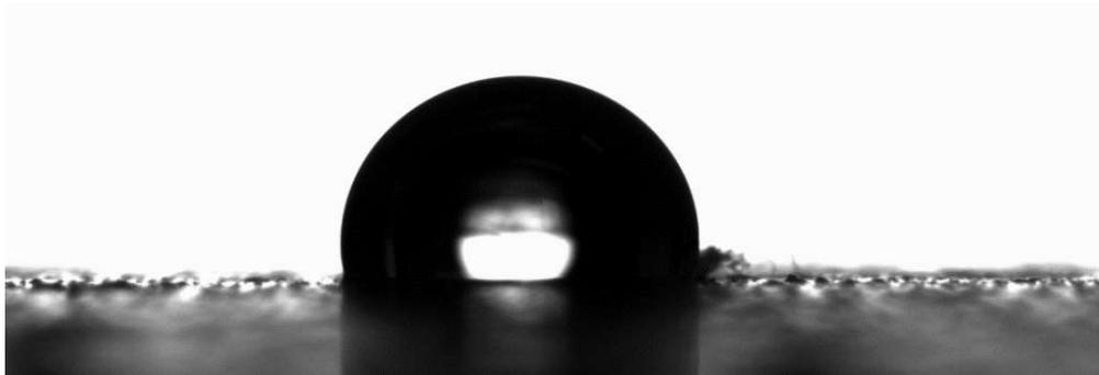
Abbildung 89 Kontaktwinkelmessung einer verunreinigten, benetzten LIPSS-Struktur nach einem Anströmversuch
