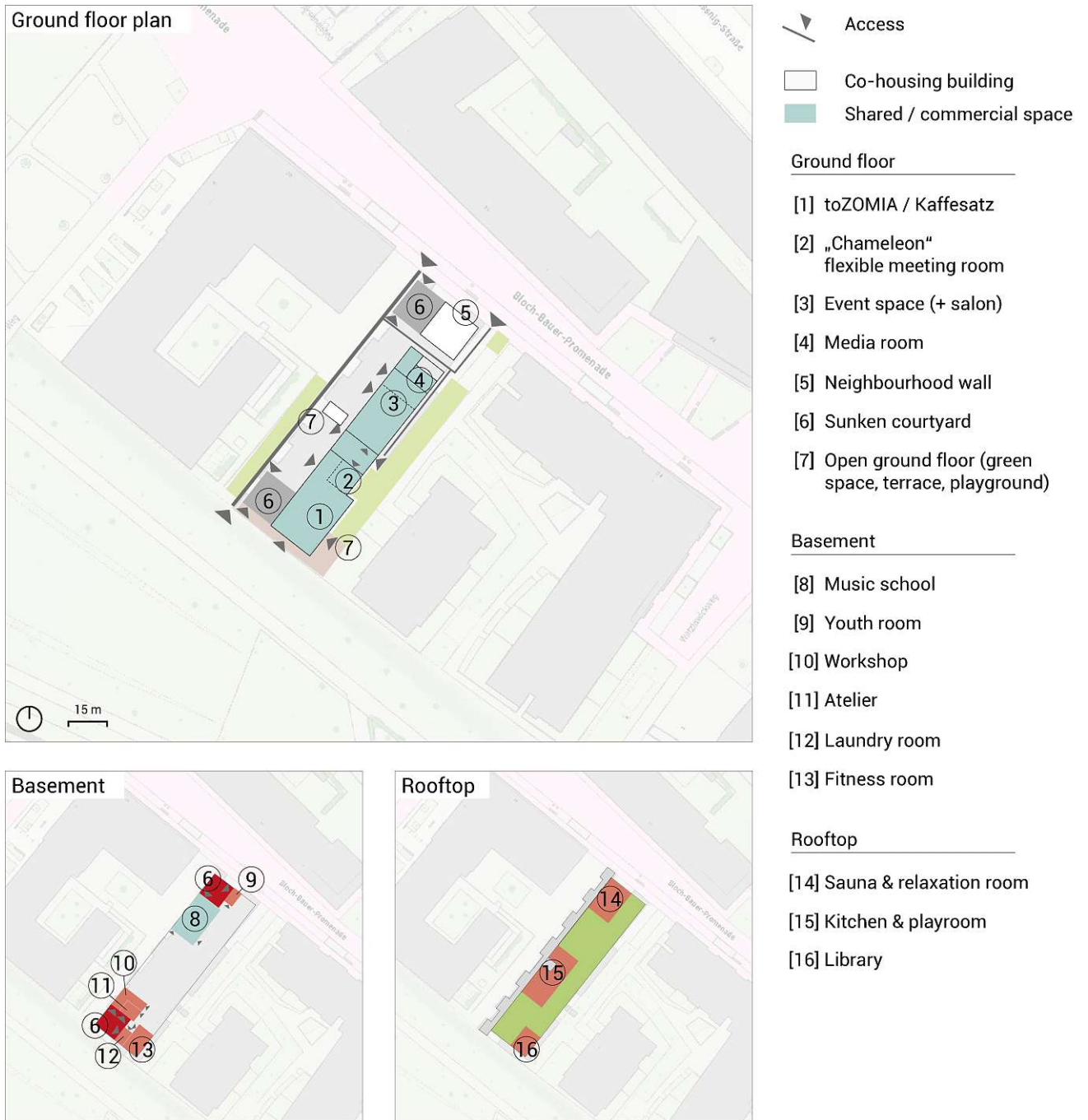
Fig. 37: Floor Plans Gleis 21 (own representation, data source: einszueins architektur 2021, map source: basemap.at )
