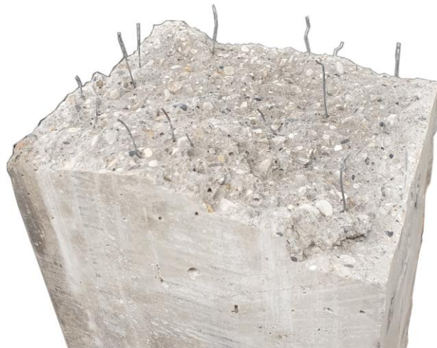
Abbildung 2.1: Faserbeton mit räumlich verteilten Fasern
