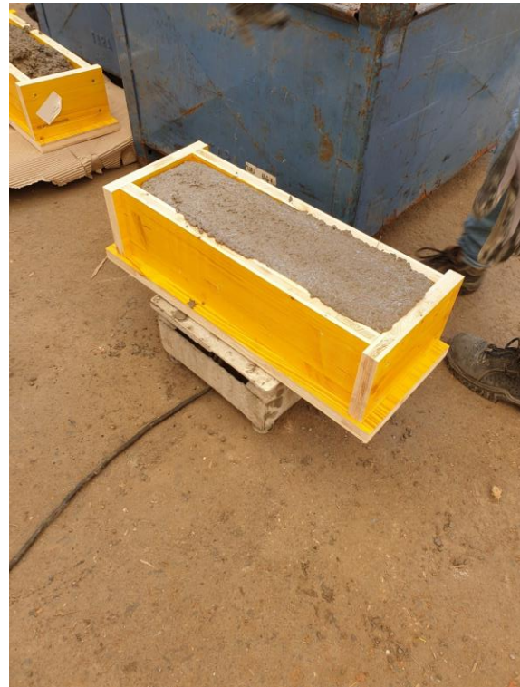
Abbildung A.4: Verdichten des Probekörpers auf einem Rütteltisch
