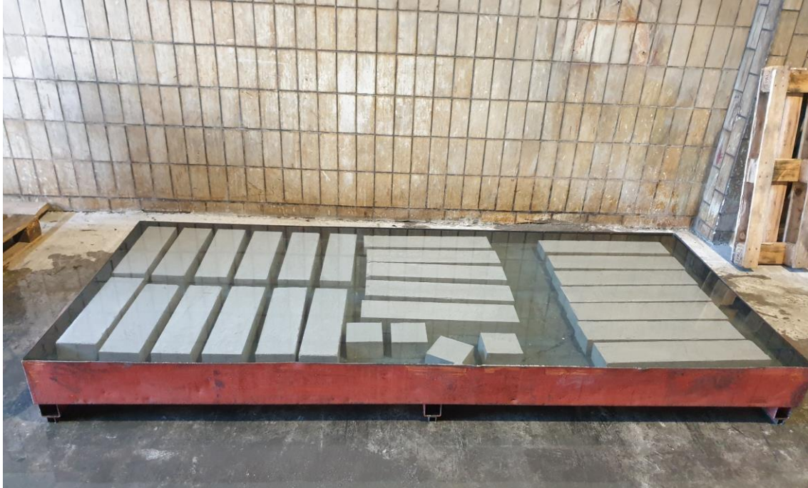
Abbildung A.7: Lagerung der Faserbetonkörper im Wasserbad
