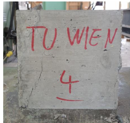
Abbildung 4.8: Rissbild nach der Druckprüfung
