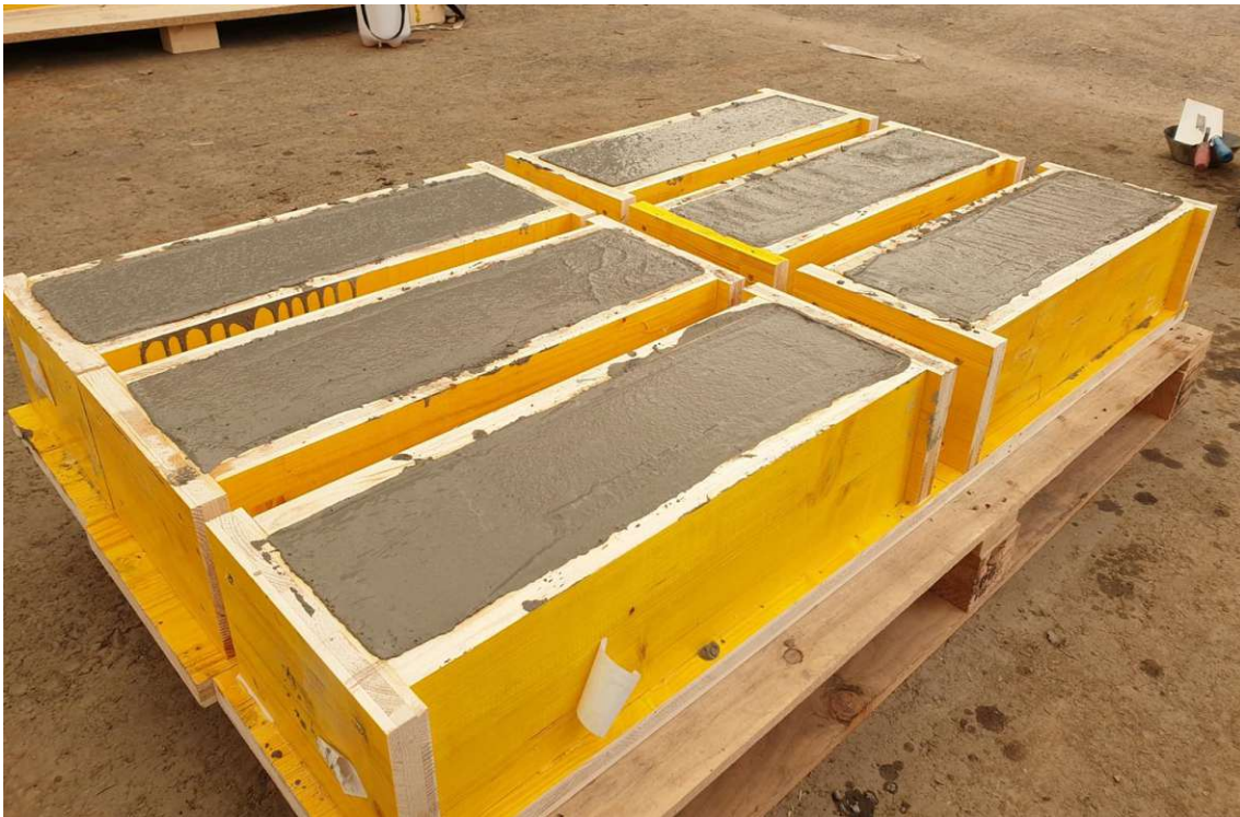
Abbildung A.5: Mit Faserbeton gefüllte Schalungen
