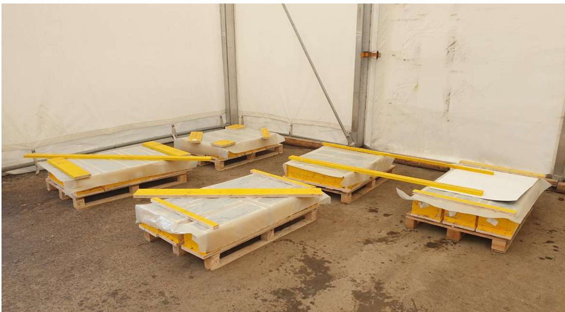
Abbildung A.6: Mit Folie bedeckte geschalte Prüfkörper
