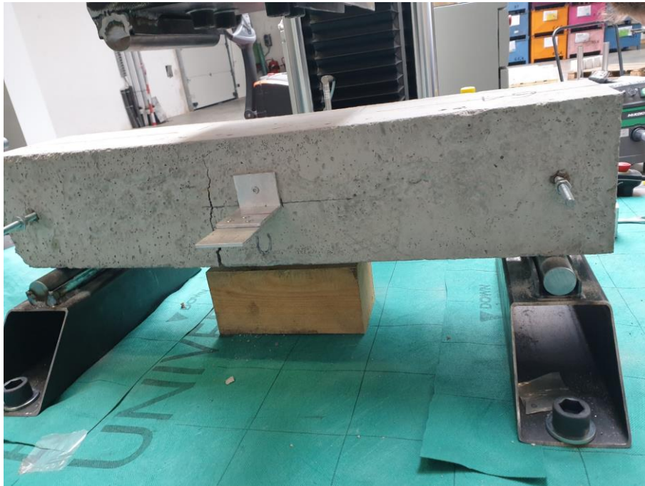
Abbildung 4.1: Abgeschlossene Faserbetonprüfung nach DAfStb-Richtlinie
