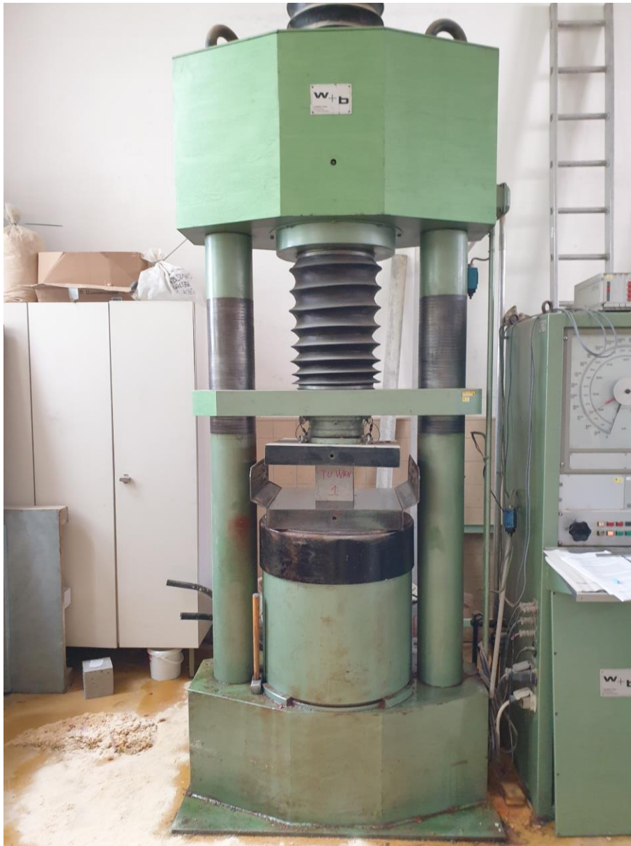
Abbildung B.3: Prüfung der Würfeldruckfestigkeit
