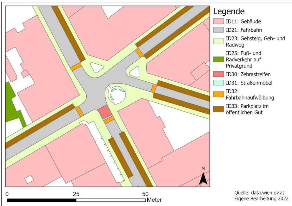
Abbildung 53: Fahrbahnaufwölbungen beim Oskar-Werner-Platz, 6. Bezirk (Quelle: data.wien.gv.at 2020, Eigene Bearbeitung 2022)
