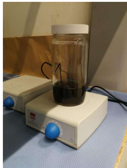
Abb. 13: Lösen/Rühren in n-Heptan
