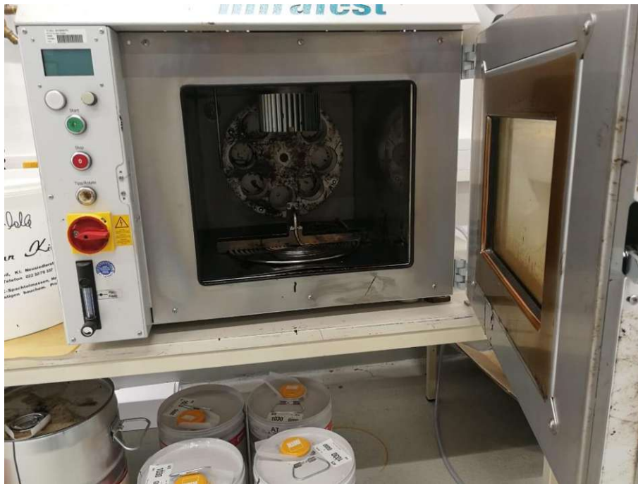
Abb. 7: RTFOT-Ofen mit Trommel für 8 Flaschen
