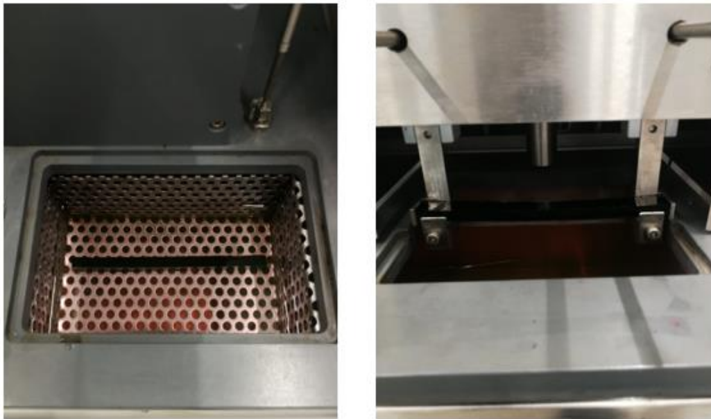
Abb. 10: Bitumenbalken im Ethanolbad (links) und in der Messvorrichtung (rechts)
