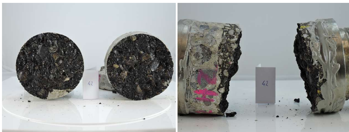
Abb. 7.25: links Probekörper 42 normal zur Trennschicht; rechts Probekörper 42 parallel zur Trennschicht
