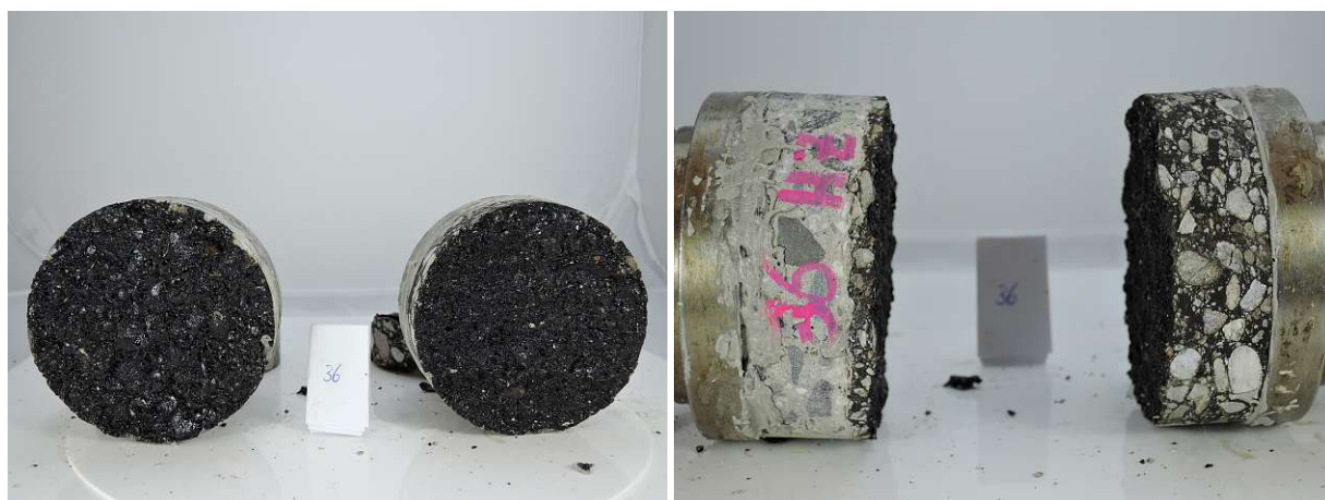
Abb. 7.22: links Probekörper 36 normal zur Trennschicht; rechts Probekörper 36 parallel zur Trennschicht
