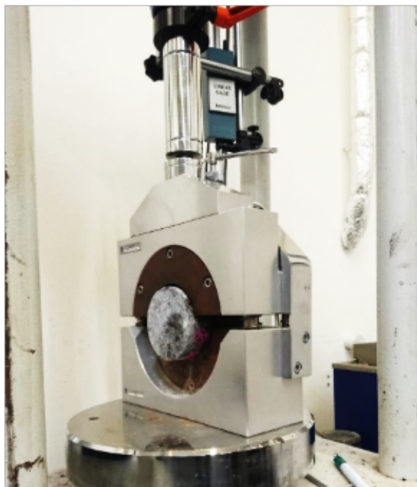
Abb. 3.7: eingespannter Bohrkern in der Schervbundprüfmaschine (Labor für Straßenbau der Technischen Universität Wien)
