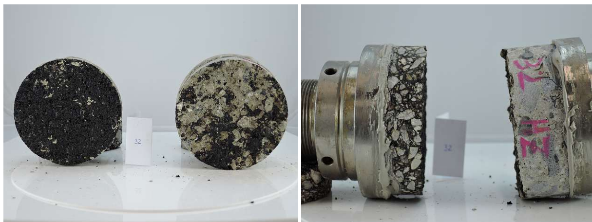
Abb. 7.21: links Probekörper 32 normal zur Trennschicht; rechts Probekörper 32 parallel zur Trennschicht
