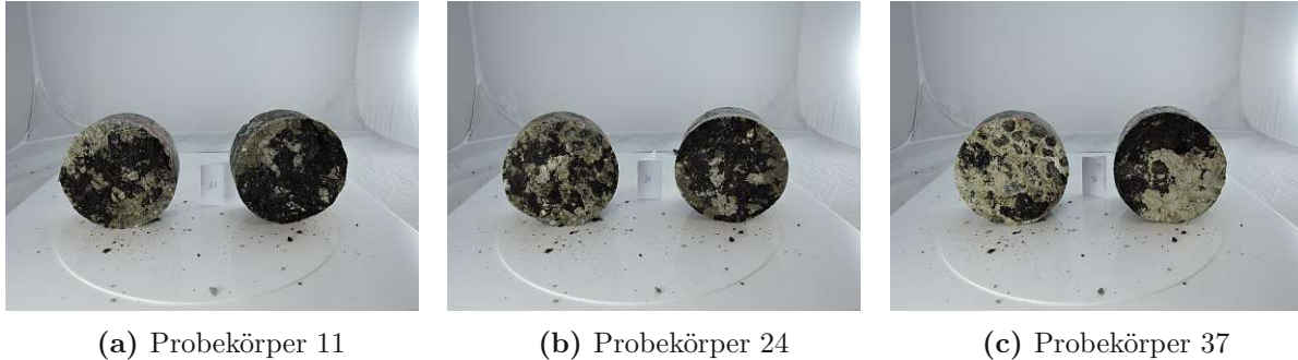
Abb. 4.22: Vergleich der drei Probekörper bei Prüftemperatur -10^{\circ}\text{C}
