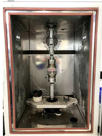
Abb. 3.9: eingespannter Bohrkern in der Haftzugprüfmaschine (Labor für Straßenbau der Technischen Universität Wien)
