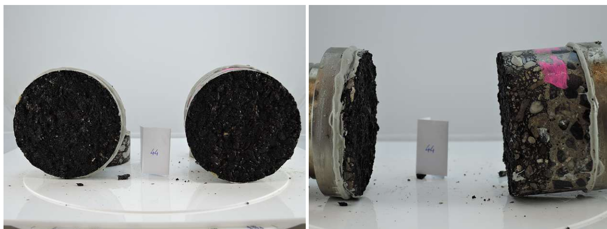
Abb. 7.26: links Probekörper 44 normal zur Trennschicht; rechts Probekörper 44 parallel zur Trennschicht
