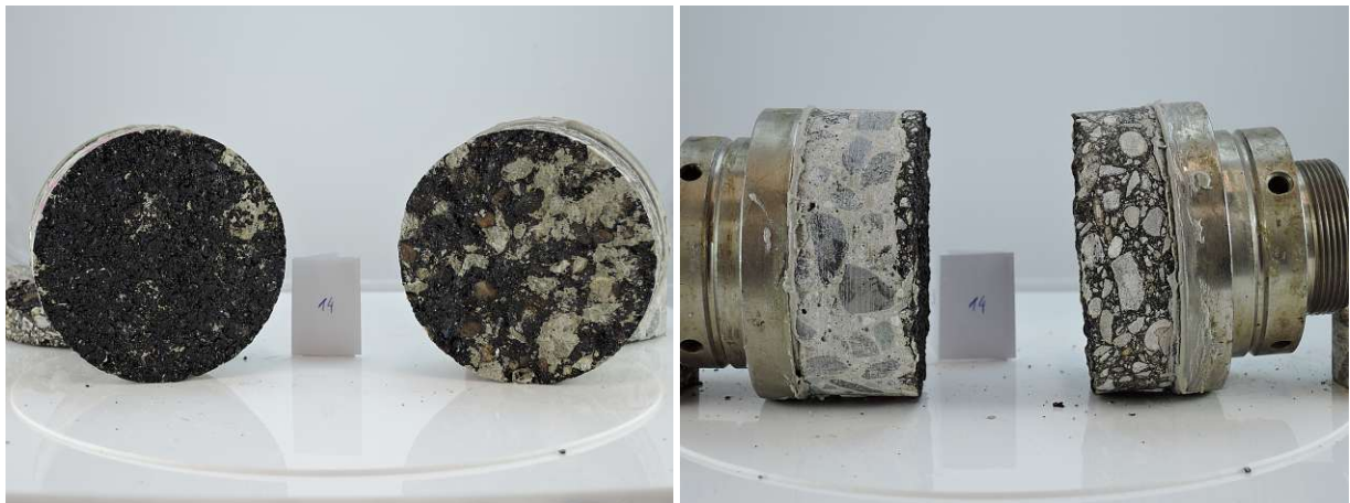
Abb. 7.19: links Probekörper 14 normal zur Trennschicht; rechts Probekörper 14 parallel zur Trennschicht
