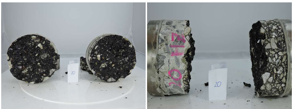
Abb. 7.20: links Probekörper 20 normal zur Trennschicht; rechts Probekörper 20 parallel zur Trennschicht
