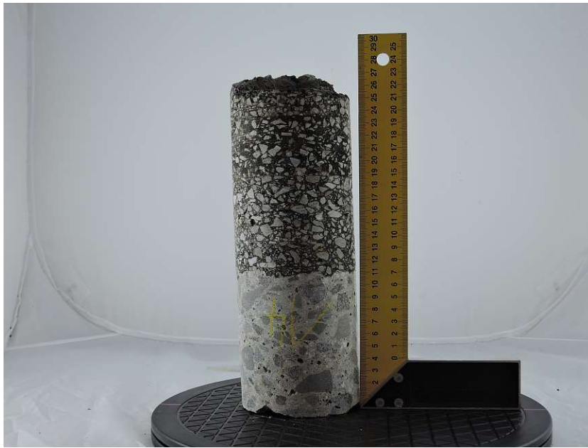
Abb. 4.8: Bohrkernprobe vor der Haftzugfestigkeitsprüfung
