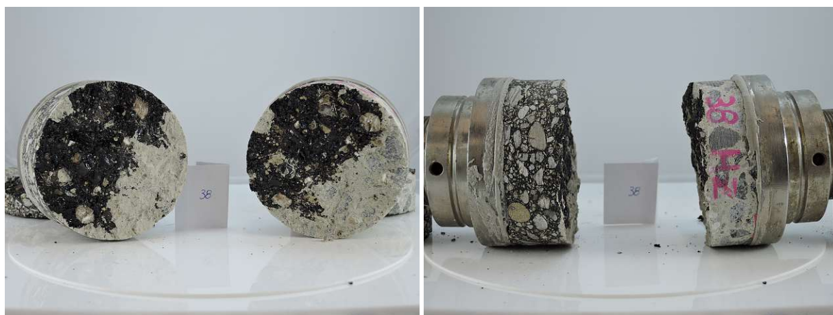
Abb. 7.23: links Probekörper 38 normal zur Trennschicht; rechts Probekörper 38 parallel zur Trennschicht
