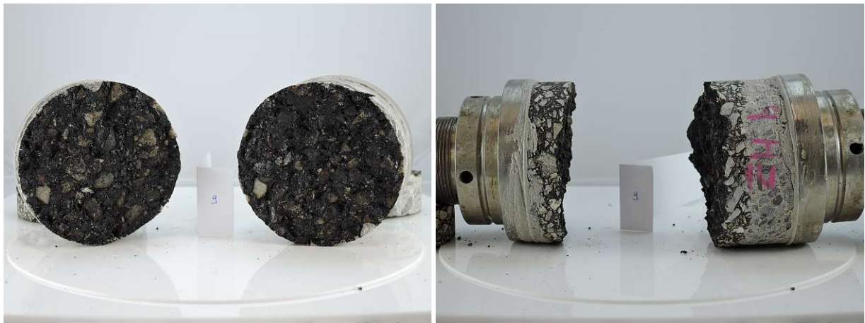
Abb. 7.18: links Probekörper 9 normal zur Trennschicht; rechts Probekörper 9 parallel zur Trennschicht
