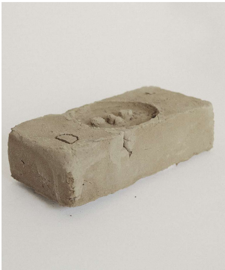
Abb. 70 Selbstgemachten Lehmziegeln aus Schichten A, D, F
