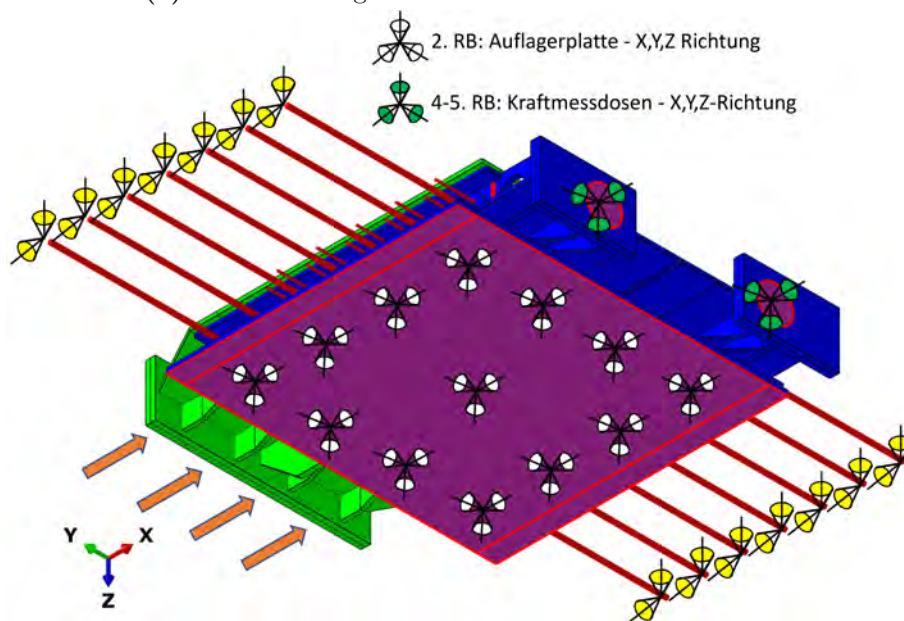
(b) Feste Freiheitsgrade auf der Unterseite des Modells
