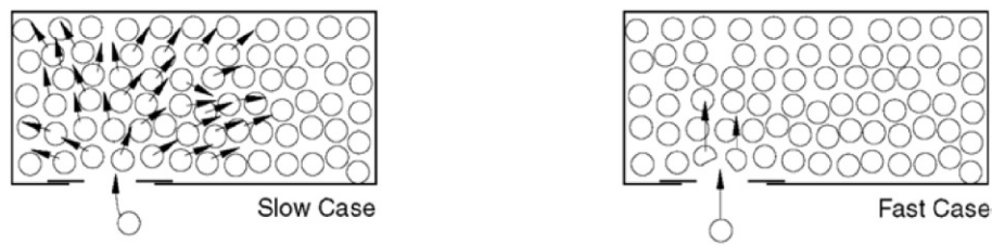
Abb. 3.1: Wellenausbreitung in der Materie mit kleiner bzw. mit großer Belastungsrate [2, S. 512]
