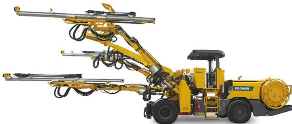
Abb. 2.2: 4-armiger Bohrwagen (Quelle: Epiroc [6])
