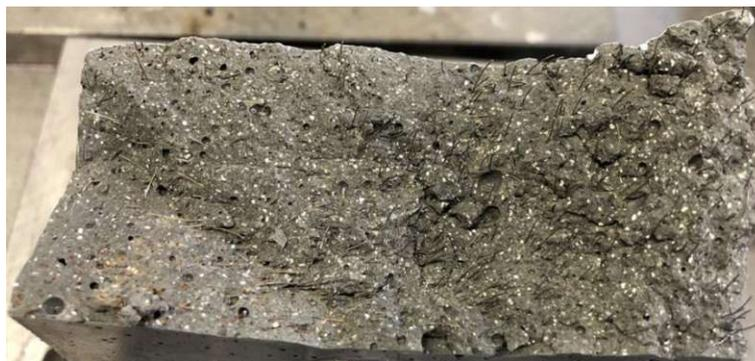
**Abb. 3.15:** Bruchfläche mit Tribokorrosion – Versuchskörper D1 FM
