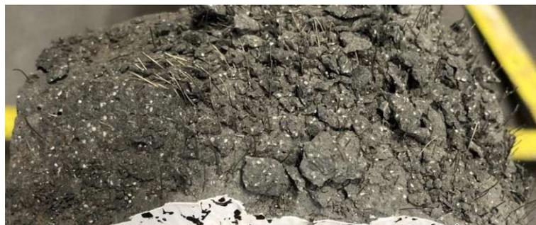
**Abb. 3.14:** Bruchfläche mit Snubbing – Versuchskörper D2 FM
