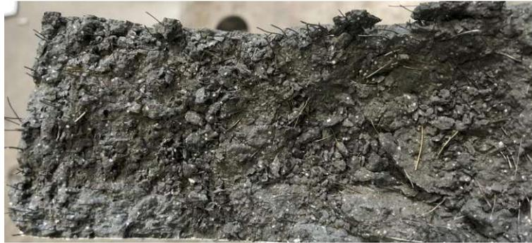
Abb. 3.16: Bruchbild des Versuchskörpers D3 FH
