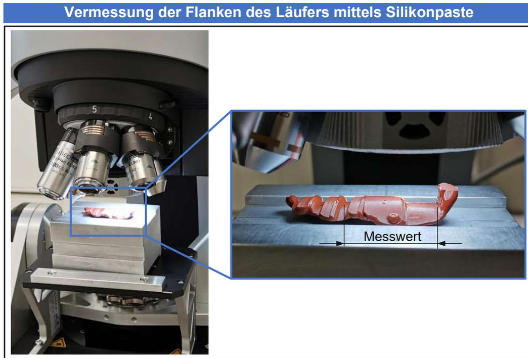
Abbildung 13: Vermessung der Silikonpaste mit dem optischen Messgerät „Alicona Infinite Focus G5 Focus G5“
