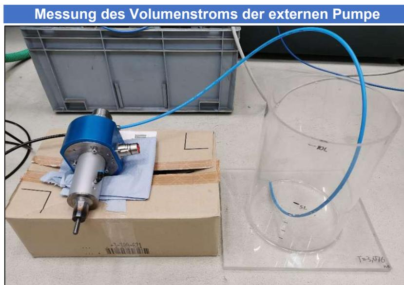
Abbildung 28: Versuchsaufbau zur Ermittlung des Volumenstroms der KSS-Zufuhr, generiert durch die externe Pumpe
