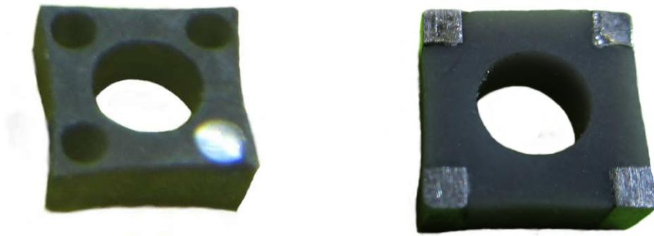
Abb. 44: Links: Quader mit einem Rundstift in den Ecken; Rechts: Quader mit quadratischen Stiften in den Ecken.
