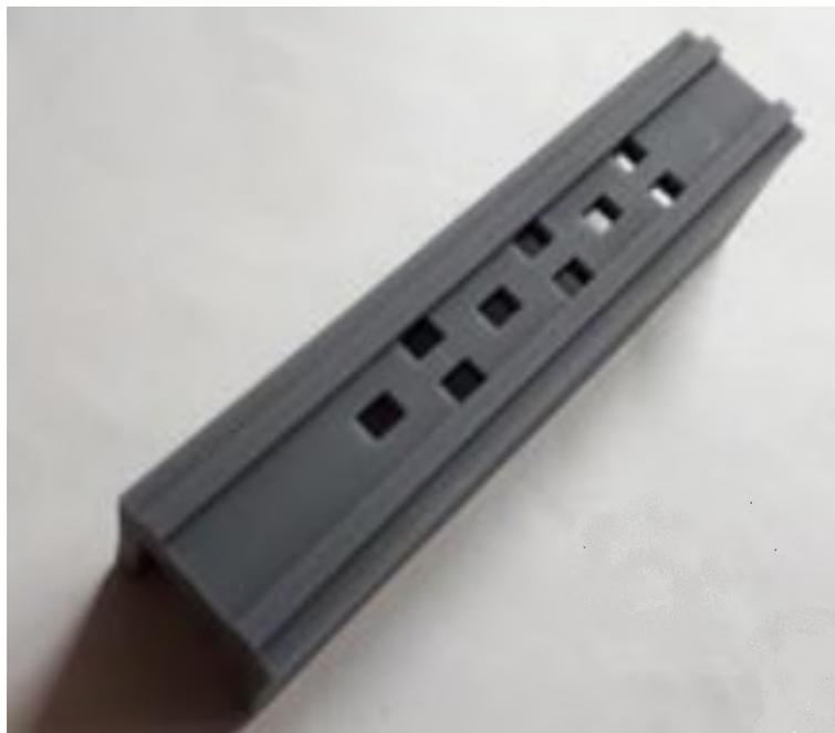
Abb. 31: Schiene zur Untersuchung des Kippmechanismus (Ataie 2018)
