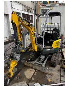
(b) Wacker-Neuson Zero Tail Kettenbagger EZ17e
