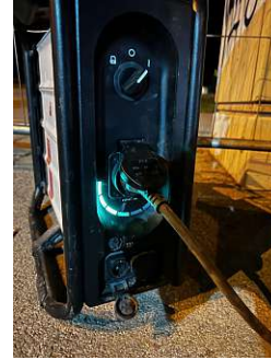
(b) 2,1 kWh Akkupacks für kabelgebundene Geräte
