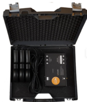
Abb. 3.2: „Metering-to-go“ der Firma LeP Lehotzki electronic Products GmbH
