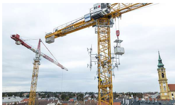
Abb. 2.12: Windräder auf Turmdrehkran [89]
