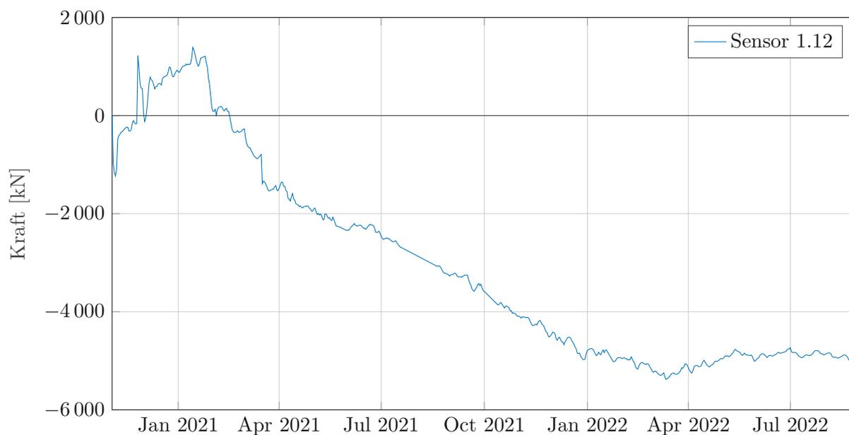
Abb. 3.11: Kraftverlauf für den Sensor 1.12 bei Marks
