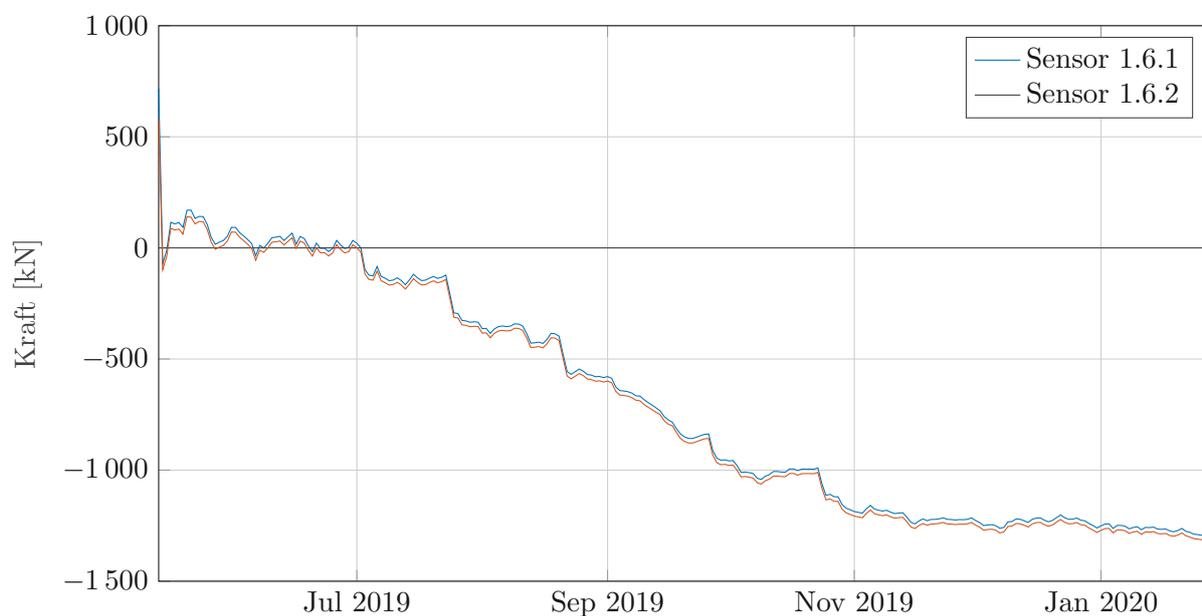
Abb. 3.12: Kraftverlauf für die Sensoren 1.6.1 und 1.6.2 bei QBC
