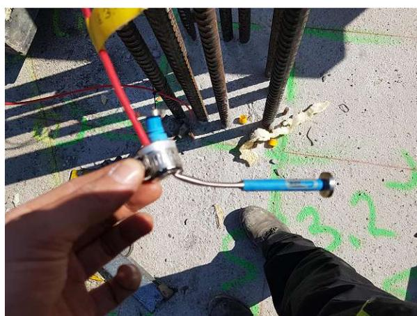
(a) Beschädigung der Schwingsaitensensoren
