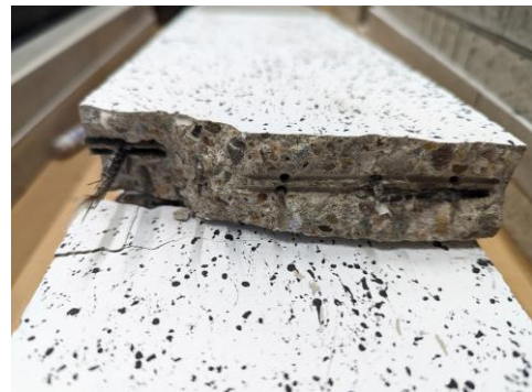
Abbildung 5: Spannungs-Dehnungs-Linie D18/V2-B und zugehöriger Bruchkörper nach Erreichen der Bruchspannung
