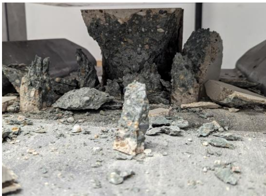
Abb. 6.3: Bruchbild der Würfelprobe W5
