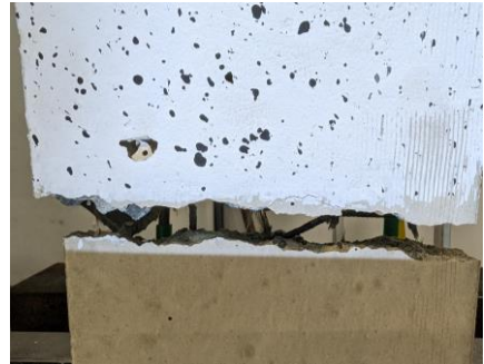
Abbildung 1: Spannungs-Dehnungs-Linie D16/V1-B und zugehöriger Bruchkörper nach Erreichen der Bruchspannung
