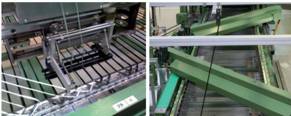
Abb. 2.3: Kettenwirkmaschine. Links: Rovings orientiert in Schussrichtung, Rechts: Rovings orientiert in Ketttrichtung, entnommen aus [17]
