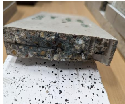
Abbildung 2: Spannungs-Dehnungs-Linie D17/V1-B und zugehöriger Bruchkörper nach Erreichen der Bruchspannung
