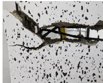
Abbildung 9: Spannungs-Dehnungs-Linie D23/V3-B und zugehöriger Bruchkörper nach Erreichen der Bruchspannung
