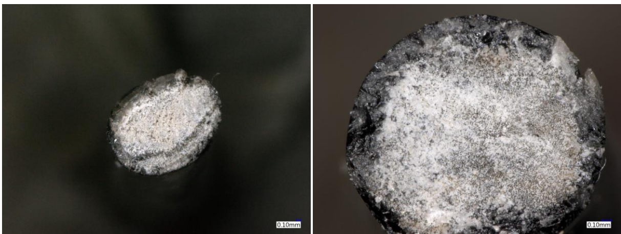
Abb. 5.3: Probenpräparation mittels Handsäge, digitalmikroskopische Aufnahme des Querschnitts. Links: Einzelroving getränkt in Epoxidharz, rechts: Einzelroving getränkt in biogenem Harz
