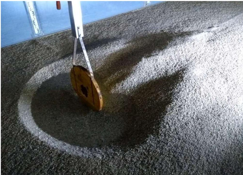
Abbildung 24: Biegesteif montierte Kreisscheibe ohne Kreiszyylinder am Ende eines Versuchs. Rinne nicht vollständig entleert, Wasser im Kolk sichtbar. (Foto: Schnauder)
