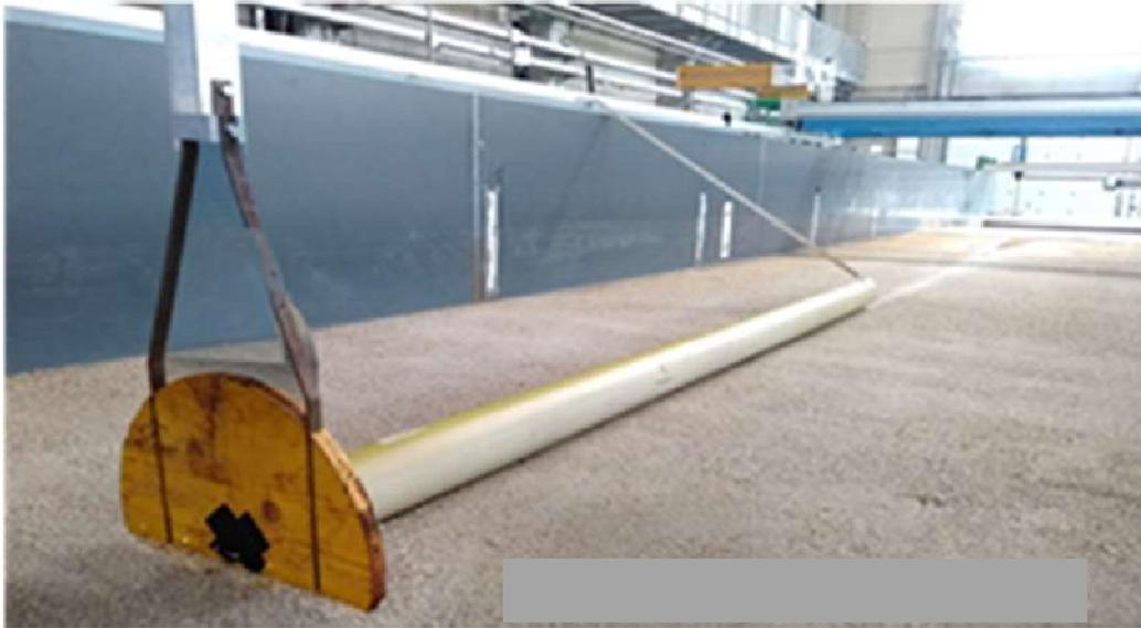
Abbildung 23: Versuchsrinne mit eingebautem Baummodell vor Versuchsbeginn. Sohle ist glatt abgezogen. Kreisscheibe zum Teil eingegraben und Kreiszyylinder liegt auf der Sohle auf. Biegesteif montierte Kreisscheibe und Lagesicherung durch Stange am hinteren Ende des Kreiszyinders. (Foto: Schnauder)
