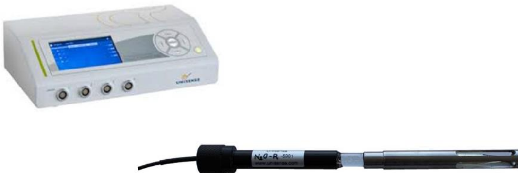
Abbildung 15: Amperometer (links), N 2 O-Mikrosensor (rechts) (entnommen aus Parravicini et al., 2015).
