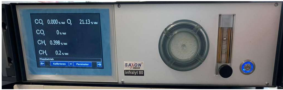
Abbildung 13: Analyser Infraclyt 80 (Firma SAXON) für die Messungen von N_2O , CO_2 und O_2 in den Luftströmen.
