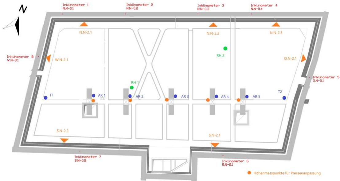
**Abb. 2.14:** Anordnung der Inklinometer im Grundriss und Messpunktbezeichnungen [54]
