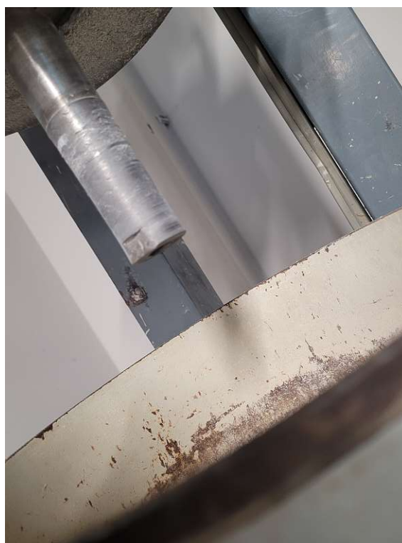
(b) Passstück und Gewindestangen-Reste
