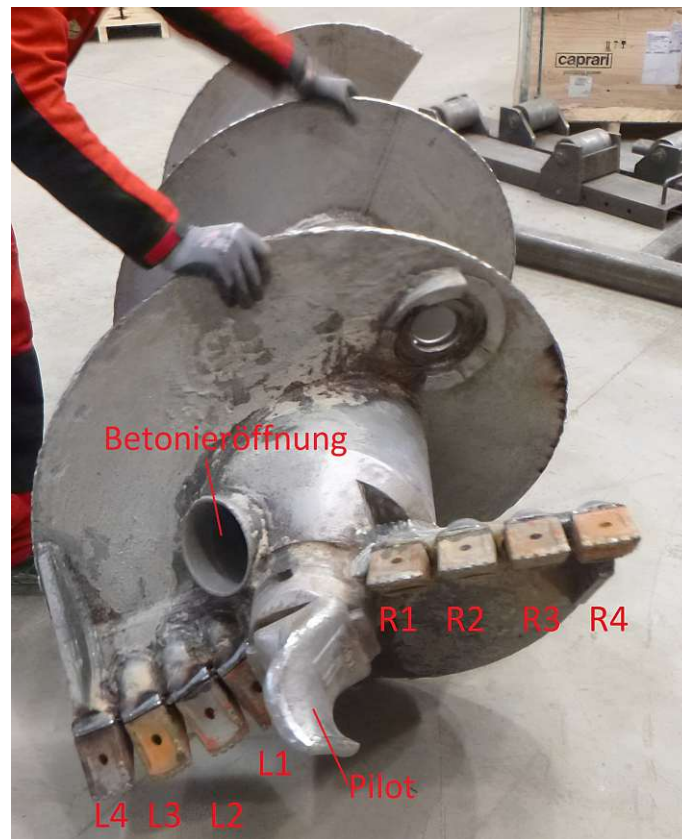
Abb. 4.6: Anfänger 110935 mit Kennzeichnung der Meißel
