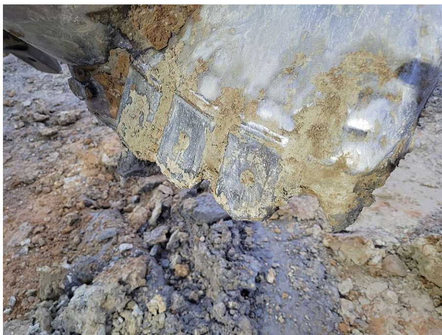
Abb. 4.9: Beispiel für verschmutzte Meißel
