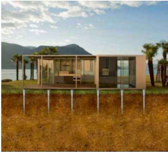
Abbildung 29: Aufbau eines Punktfundamentes – Quellen: baustoffwissen.de, 2015 (links) | energieleben.at, 2021 (rechts)
