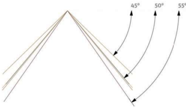
► 141 Überlagerung der vorgefundenen Dachneigungen. Eigene Darstellung
