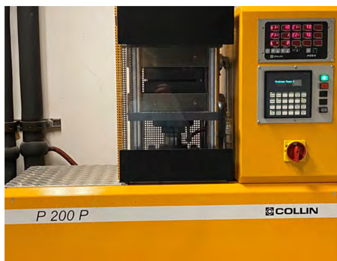
Abbildung 23: Plattenpresse Collin P200P, mit welcher die Platten hergestellt wurden
