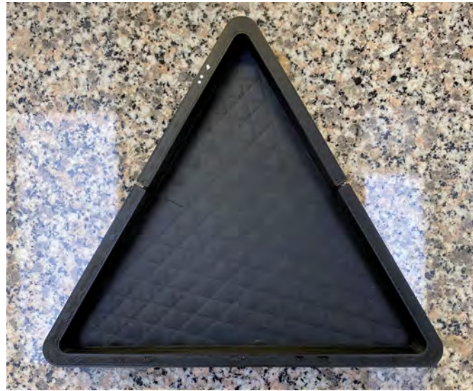
Abbildung 26: Vorrichtung zur Herstellung der Segmente mit 120° Winkel Ausschnitt
