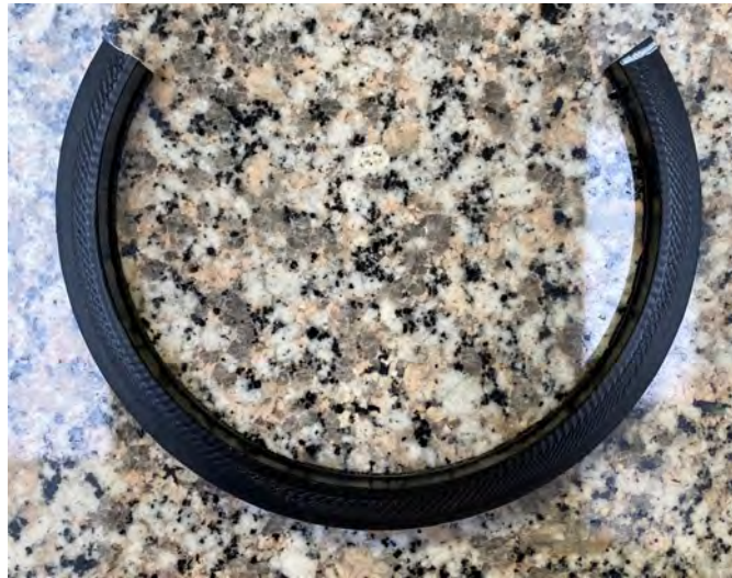
Abbildung 24: Rohrsegment zur Untersuchung der Eigenspannungen nach dem Herausschneiden eines 120° Stückes
