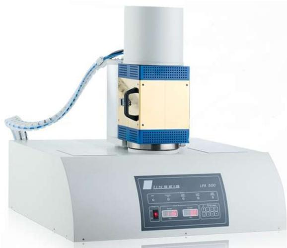
Figure 3.16: Laser flash apparatus Linseis LFA 500<sup>TM</sup>
