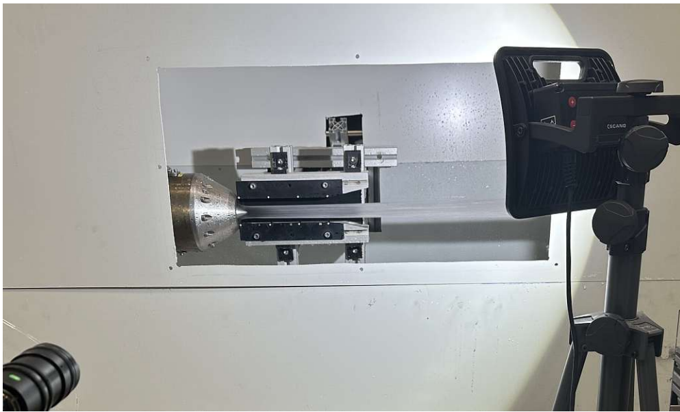
Abbildung 3.9: Aufbau für die Strahlvermessung
