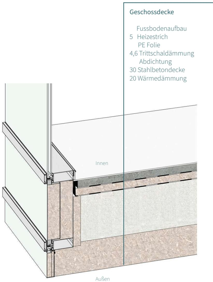
Geschossdecke, Metall-Glasfassade, Fußpunkt Deckenanschluss
