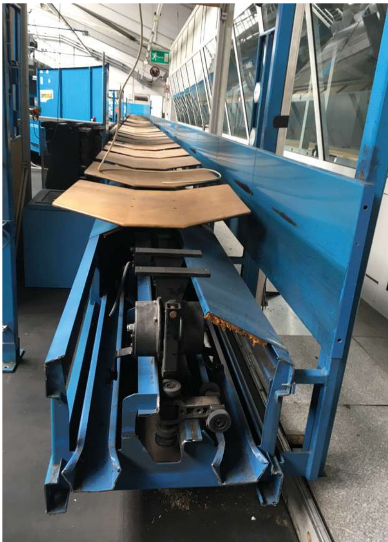
Abb 20: PVZ Codierebene. Das Codierband wurde nach der Stilllegung durchgeschnitten. © Magdalena Klaus
