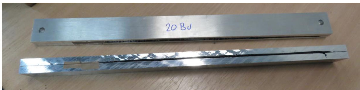
Abbildung 17: Verklebte ENFv2-Proben mit durch Bolzen gesicherte Füge­teile.
