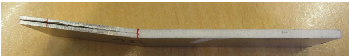
Abbildung 64: Plastisch verformter ENFv1-Probenkörper nach der Versuchsdurchführung.
