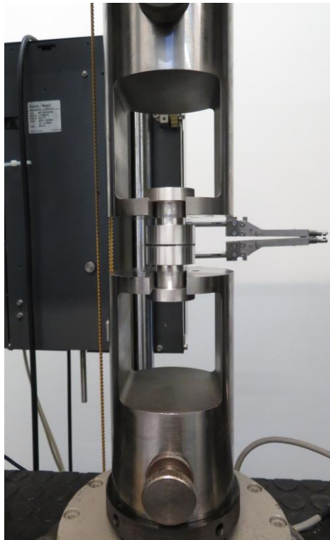
Abbildung 21: Versuchsaufbau des Thick Adherend Tensile Tests (TATT).
