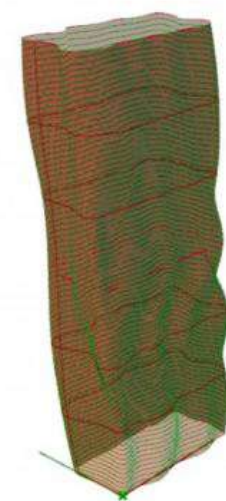
Abb.75: Erstellung von wellenförmigen Fassadenelementen
