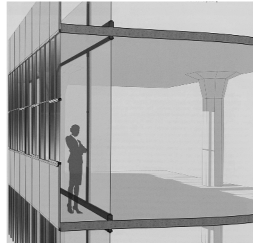
Abb. 320 Original- (l.) und Sekundärverglasung (r.)
