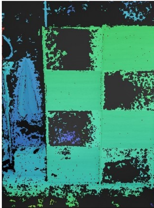
Abbildung 5: In Metashape berechnete Depth-Map für das Foto aus Abbildung 3. Grüne Punkte befinden sich näher, blaue weiter hinten.
