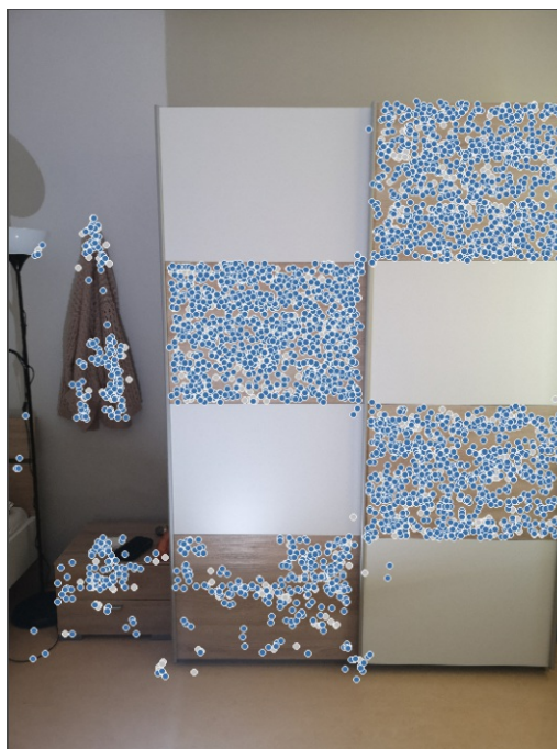
Abbildung 3: Ein Beispiel für extrahierte Features aus dieser Arbeit. Auf dem stark texturierten Kasten (Raum 3) sind sehr viele Punkte zu finden, während an den Wänden so gut wie keine Punkte vorhanden sind
