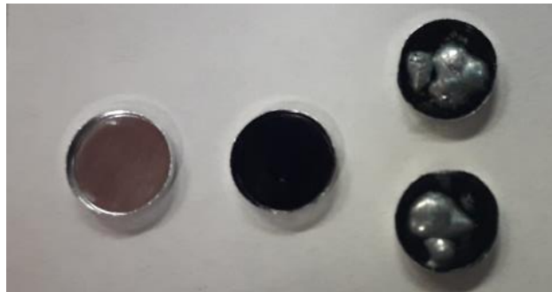
Abbildung 29: DSC: Messtiegel unbeschichtet (l), beschichtet (m) und mit Galliumeinwaagen aus zwei Galliumkörnern (r)
