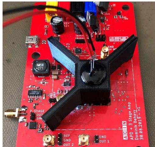
(b) Mit eingeklebter LED.
