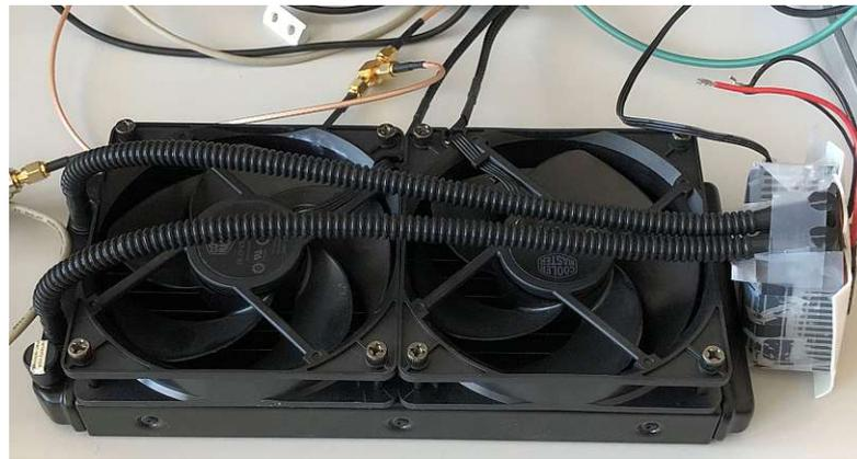
Abbildung 4.1: Foto des Kühlmoduls, bestehend aus Peltierelement, Wasserpumpe und Kühlgerippe mit Lüftern.
