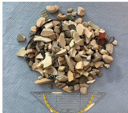
**Abb. 8** Mineralische Restfraktion aus der Partikelgrößenfraktion 8–16 mm der Bettasche nach einem Sortierdurchgang
