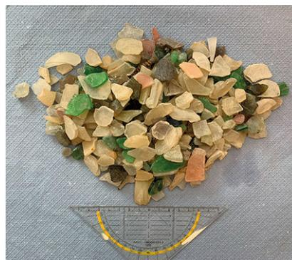
**Abb. 7** Glas aus der Partikelgrößenfraktion 8–16 mm der Bettasche nach einem Sortierdurchgang
