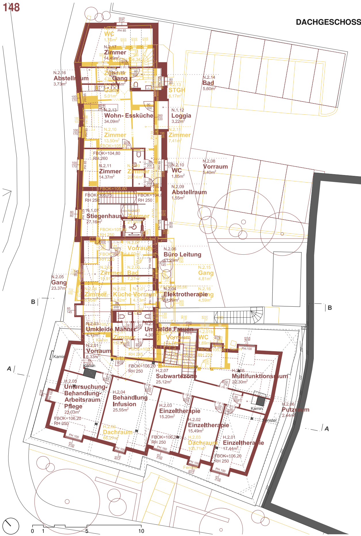
Abb. 152: Bauliche Eingriffe Grundriss Dachgeschoß
