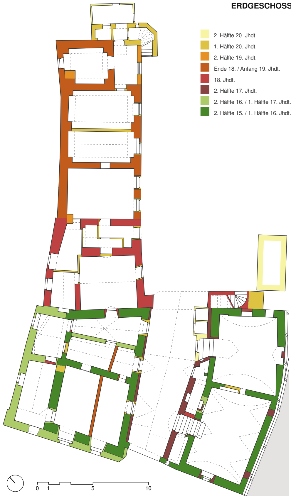
Abb. 82: Baualtersplan Grundriss Erdgeschoß / Kellergeschoß
