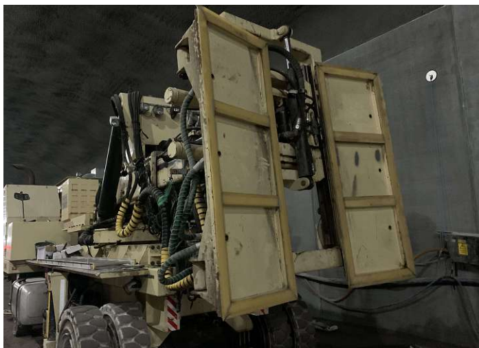
Abb. 4.6: Erektor zur Manipulation der Wandelemente (Quelle: Eigene Aufnahme)
