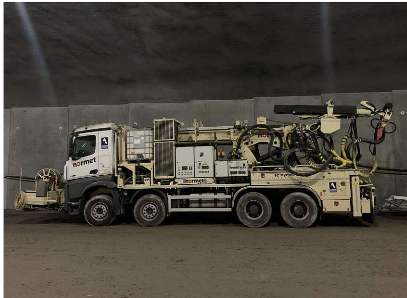
Abb. 4.8: Spritzbetonmanipulatoraufbau auf einem LKW (Quelle: Eigene Aufnahme)
