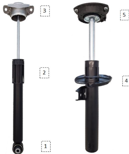
Abbildung 1.2: Häufig verwendete Zweirohrdämpfer als DV: (links) (2) Hinterachsdämpfer mit (1) Fußlager und (3) Stützlager ohne Anschlagpuffer; (rechts) (4) Vorderachsdämpfer mit (5) Stützlager ohne Aufbaufeder und ohne Anschlagpuffer
