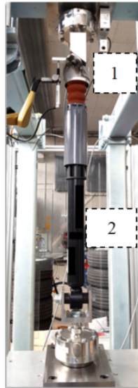
Abbildung 3.4: Typischer DV Testaufbau am DVP mit 1) Stützlager und 2) Hinterachsdämpfer in Zweirohrbauweise
