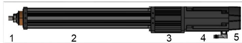
Abbildung 3.5: Linearaktuator bestehend aus 1) linear geführtem Kolben, 2) Linearmodul FT35-1210, 3) Kupplung, 4) AC Servomotor (PSM) und 5) Bremse
