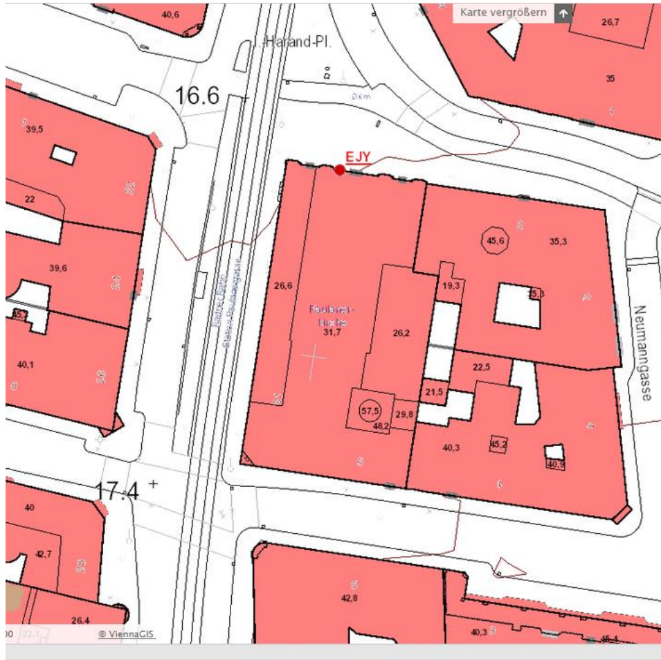
Abbildung 46 Geodatenviewer der Stadtvermessung Wien – Kartenausschnitt bei der Paulanerkirche (Stadt Wien - Geodatenviewer, 2023); In Rot ist der Höhenfestpunkt “EJY” am Irene-Harand-Platz markiert, der sich 17,438 m über dem Wiener Null beziehungsweise 174,118 m.ü.A. befindet (rechts vom Haupteingang). Entlang der Wiedner Hauptstraße sind die Höhen 16,6 und 17,4 angegeben, was Meter über der Wiener Null (156,68 m.ü.A.) entspricht.
