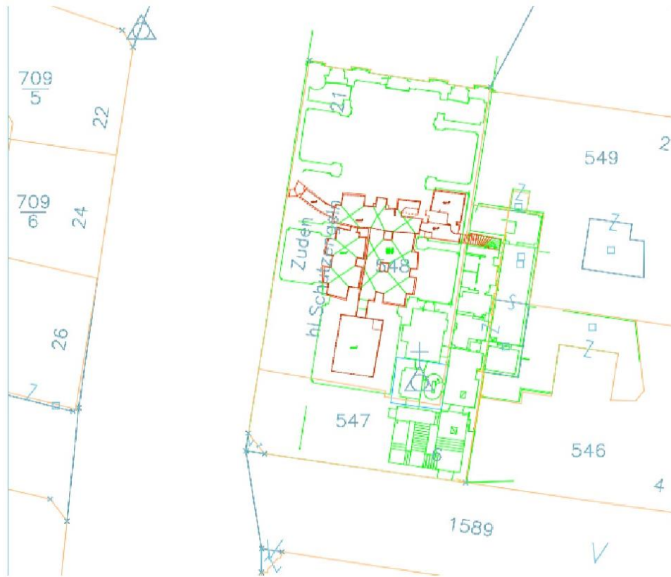
Abbildung 36 Übereinanderlegung der Pläne des Erdgeschosses (grün) und des Kellergeschoßes (Krypta; rot) zur Orientierung der Krypta (der Plan ist eingemordet) (Wagner, 2017 - 2022)
