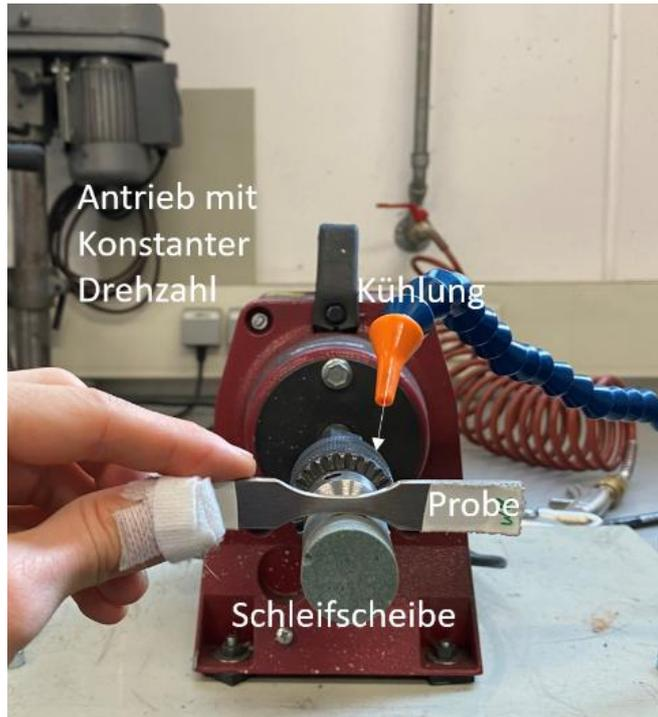
**Abbildung 32: Schleifvorrichtung für Proben 14-7PH**
