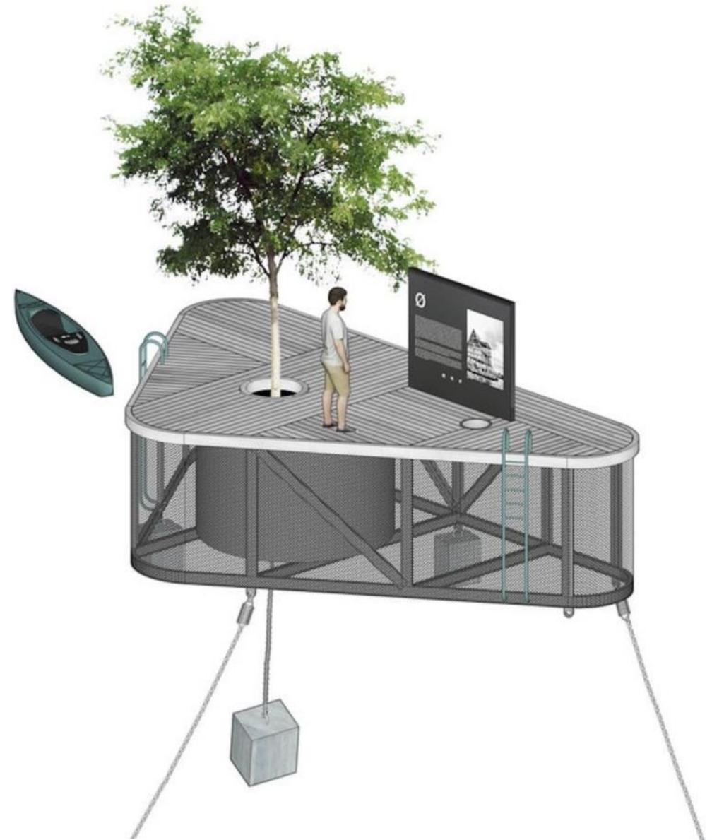
Abb.51. Schematische Darstellung einer Beton-Block-Verankerung
