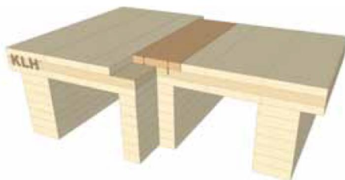
Abb. 3.27: Querverbindung mit verschraubtem Deckbrett [19]
