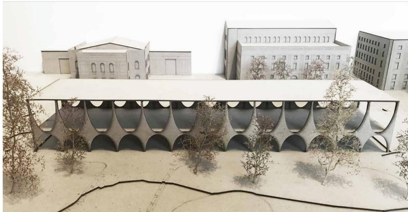
massive, gebogene Fassade leitet sich vom Tragsystem ab - Rahmensystem bündig an Fassadenbögen
