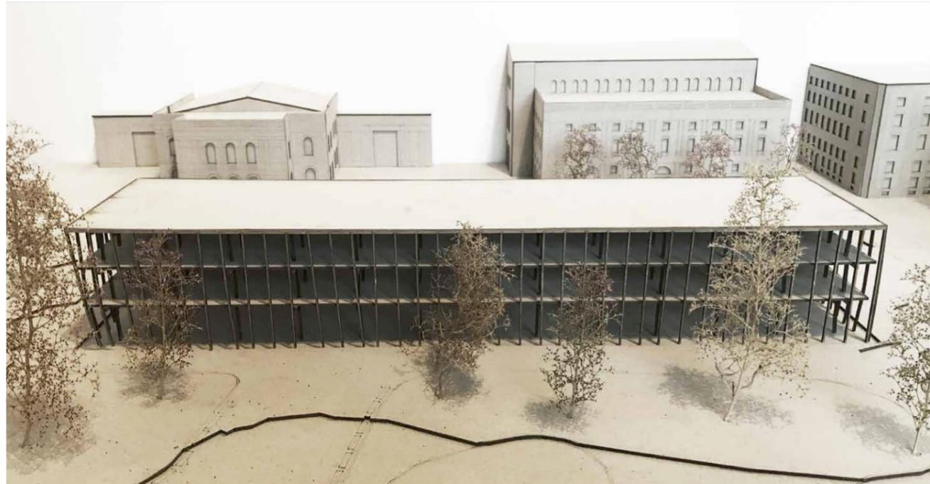
filigrane, geradlinige Fassade unabhängig von Tragsystem - Vierendelträger sind nach innen versetzt
