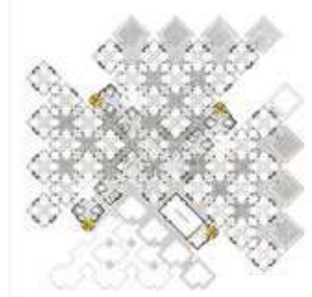
Abb.17 Herman Hertzberger, Centraal-Beheer Bürogebäude, Grundriss des 4. Obergeschosses. 1968-72. Auf den 4. und 5. Obergeschoss befinden sich zweigeschossige Büros.
