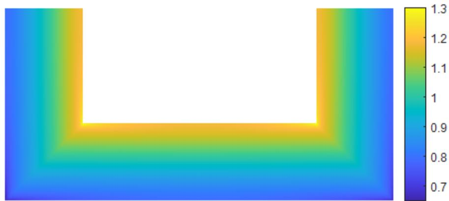
Abbildung 6.12: Flussdichteverteilung im Hauptpaket zum Zeitpunkt  $t = 5\text{ms}$  bei einer Versorgung von  $1\text{T}$ .
