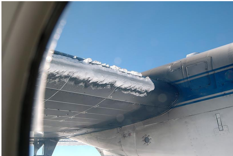
Abbildung 1 – Ausbildung einer Horn-Eisformation auf der Leading Edge der Tragfläche einer „de Havilland Canada DHC-6 Twin Otter“ während des Fluges im Rahmen eines NASA Forschungsprojektes [15].
