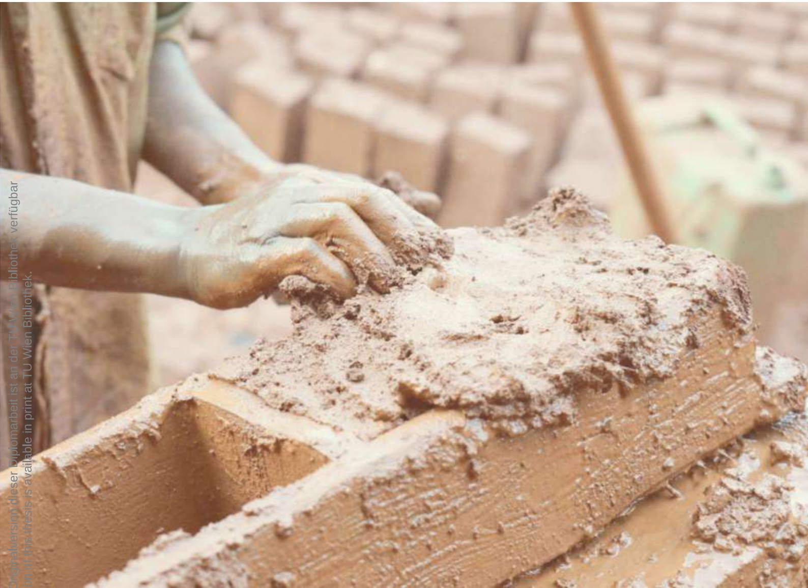
Abb. 34: Lehm wird in Holzformen zu Ziegeln geformt
